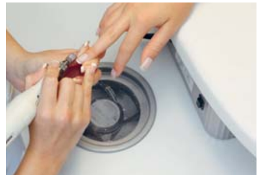
Bild 9: Nagelbearbeitungstisch mit Absaugeinrichtung
