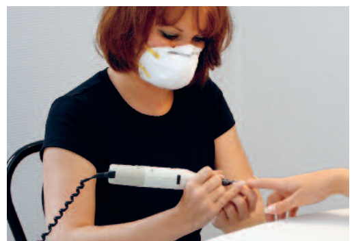
Figure 10: porter un masque de protection respiratoire lors de longs travaux de polissage.
