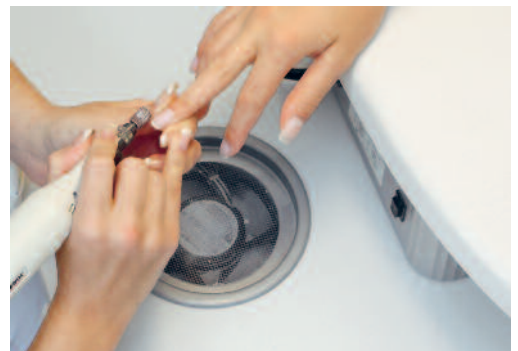
Figure 9: table de traitement des ongles avec installation d'aspiration.
